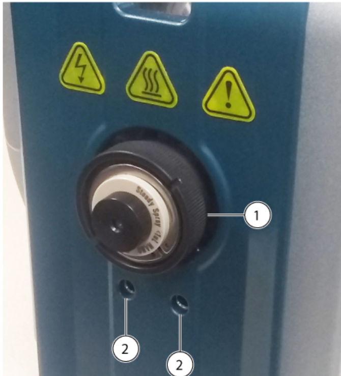
Figura 3-18 Conexão do aquecedor de coluna Nano à fonte de íons
