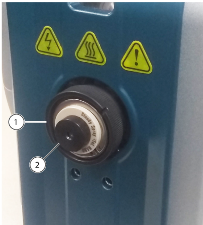
Figura 3-13 União instalada na sonda Nano
