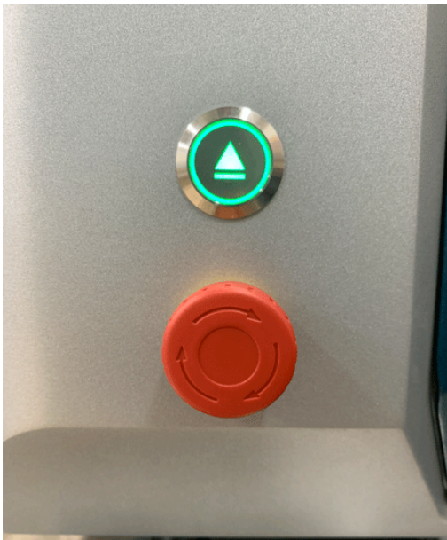
Figura 6-3 Girar hacia la derecha el interruptor de apagado de emergencia
