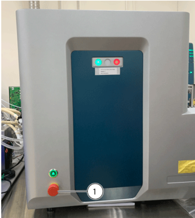
Figura 6-1 Interruptor de apagado de emergencia en el panel frontal del módulo Echo® MS
