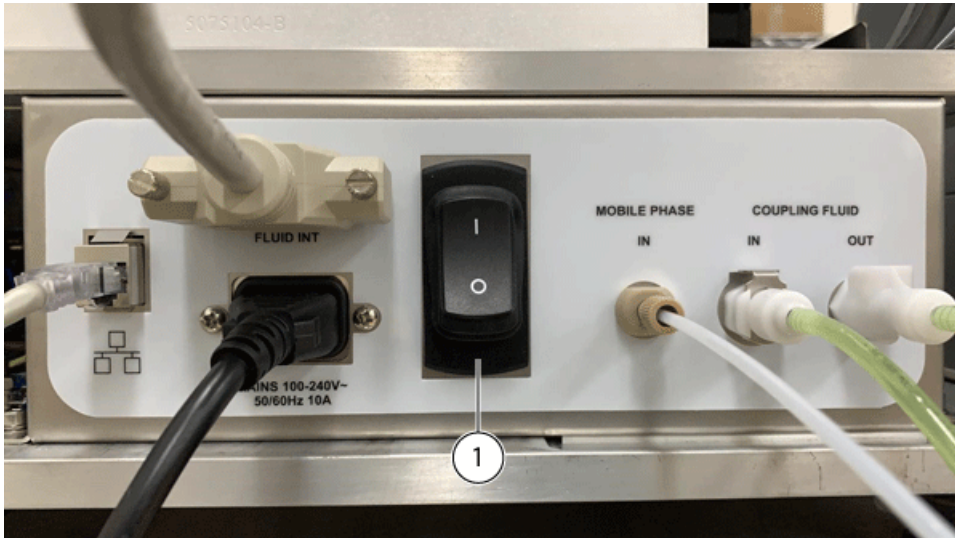
Figura 4-2 Interruptor de corriente del módulo Echo ® MS
