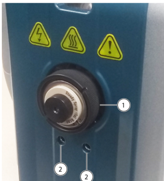
Figure 3-18 Connexion de l'élément chauffant de la colonne Nano sur la source d'ions
