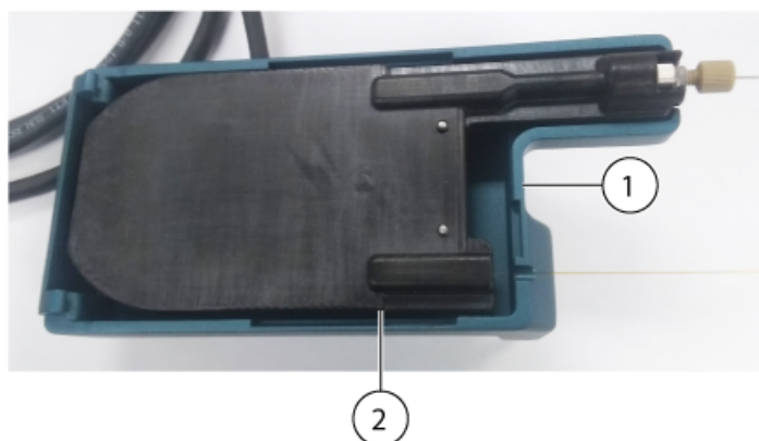
Figure 3-15 Partie arrière du chauffage de la colonne Nano
