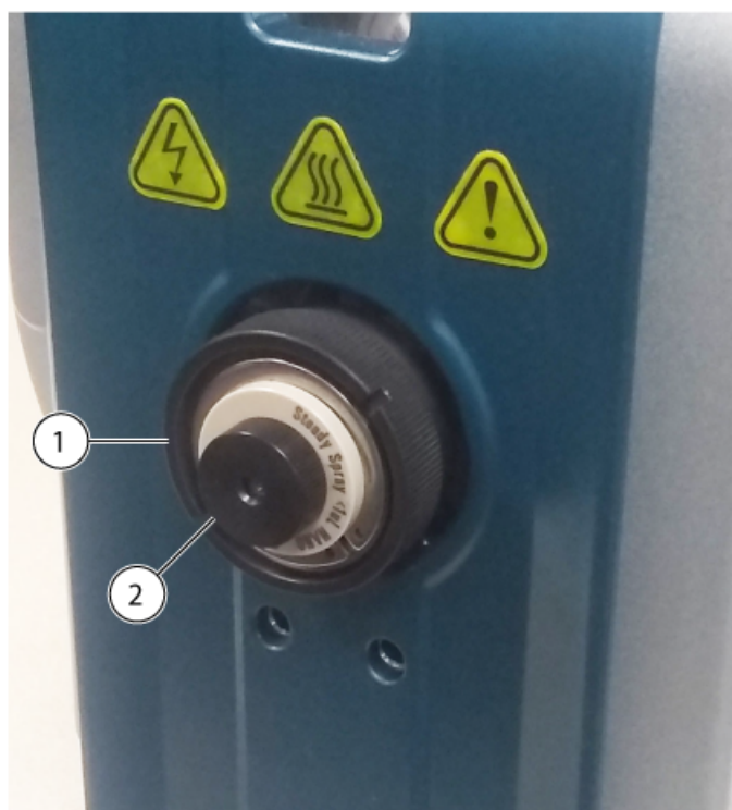
Figure 3-13 Jonction installée dans la sonde Nano
