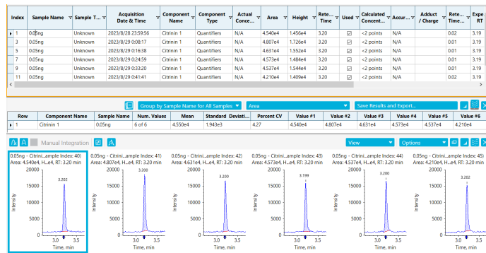
图4. 0.05 ng/ml浓度连续进样6针色谱图，峰面积、保留时间及RSD结果列表
