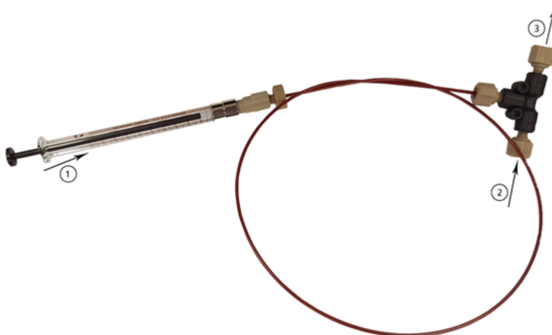
Figura 4-1: Configuração da infusão em T
