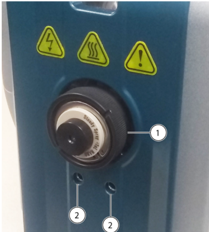
Abbildung 3-18 Anschluss der Nano-Säulenheizung an der Ionenquelle
