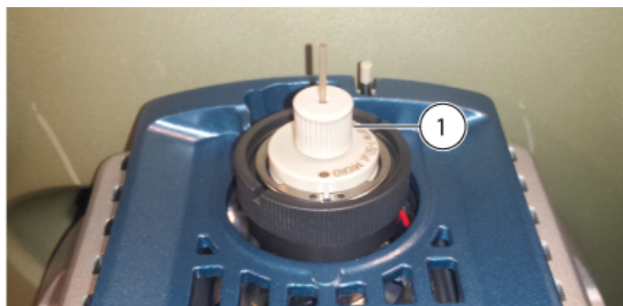
图 3-3 已安装下方接头
