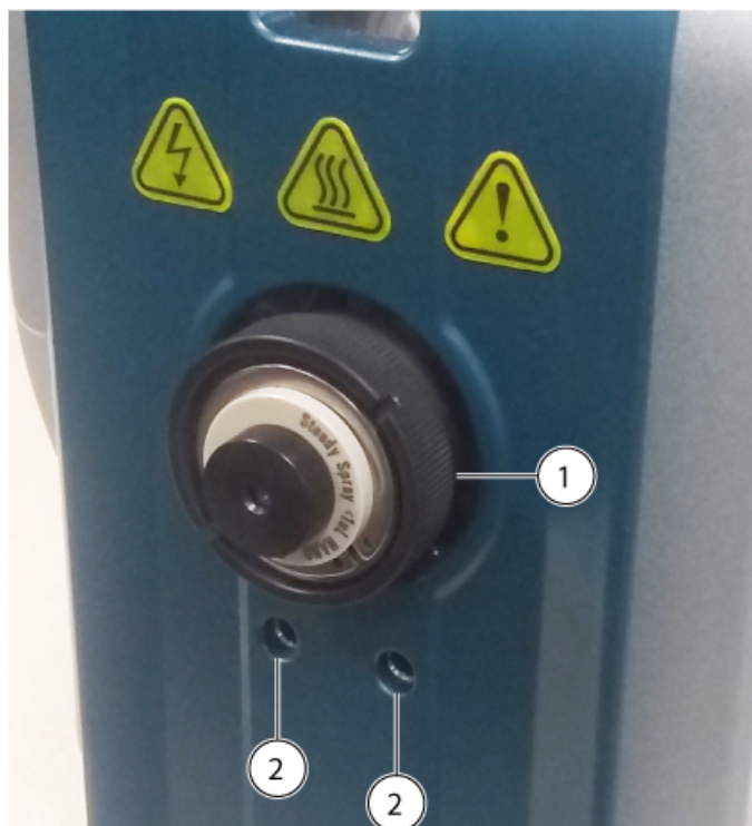
图 3-18 连接至离子源的 Nano 色谱柱加热器
