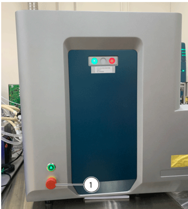
図 6-1 Echo ® MSモジュールの前面パネルの緊急停止スイッチ
