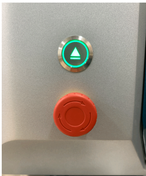
図 6-3 緊急停止スイッチを時計回りに回す
