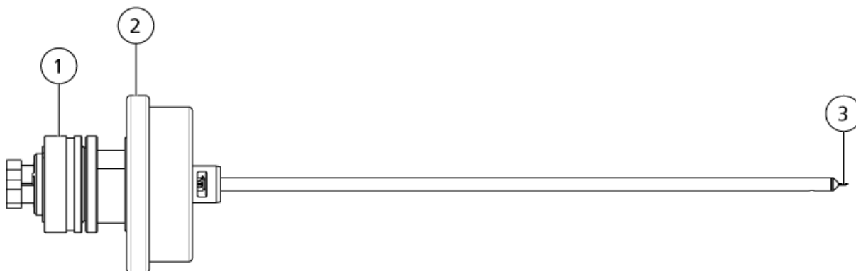
Figura 1-2 Parti della sonda ESI doppia
