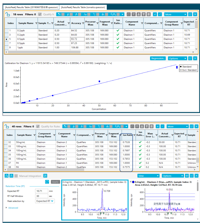
图9. 定量线性及Ion Ratio (以二嗪磷为例)。
