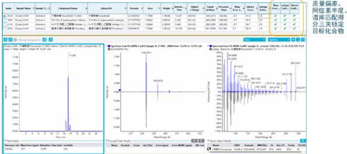
图6. nonTarget提峰结果，链接到在线数据库定性得到1,3,2,4-二甲苯
