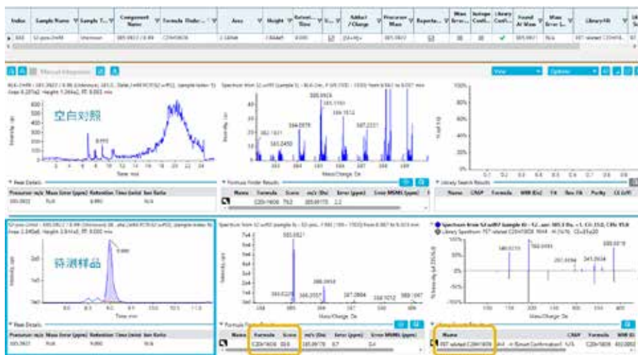
图5. nonTarget提峰结果示例，提示该化合物和PET相关
