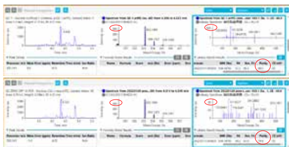
图5. 某样本中咖啡酰蔗糖在开启和关闭Zeno trap时的二级谱库匹配结果对比：在母离子响应相同的情况下，Zeno trap将二级响应提高了12倍以上，谱库匹配得分也由79分上升到96分，增加了对鉴定结果的信心。
