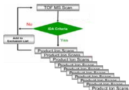
图2. 动态背景扣除_数据依赖性扫描（DBS_IDA™、根据基质复杂程度，可以设置关联二级扫描谱图数目，最多可以关联100张二级扫描）。
