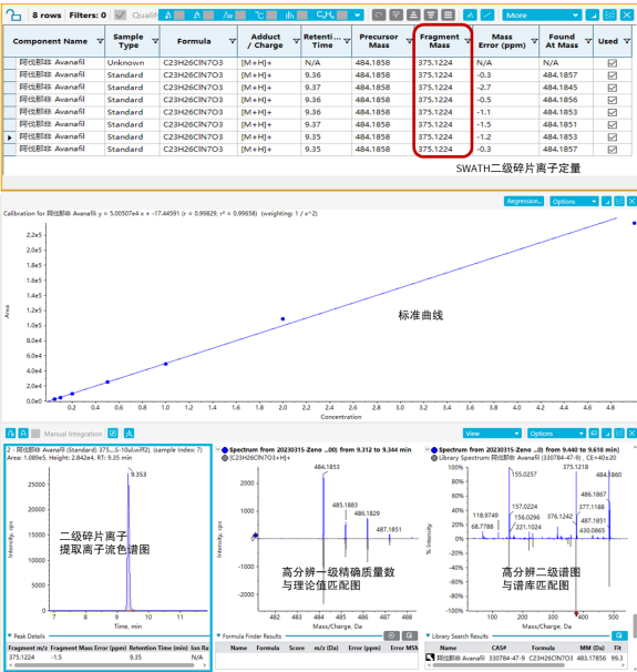
图10. Zeno™ SWATH® DIA技术同时完成阿伐那非的定量和定性举例
