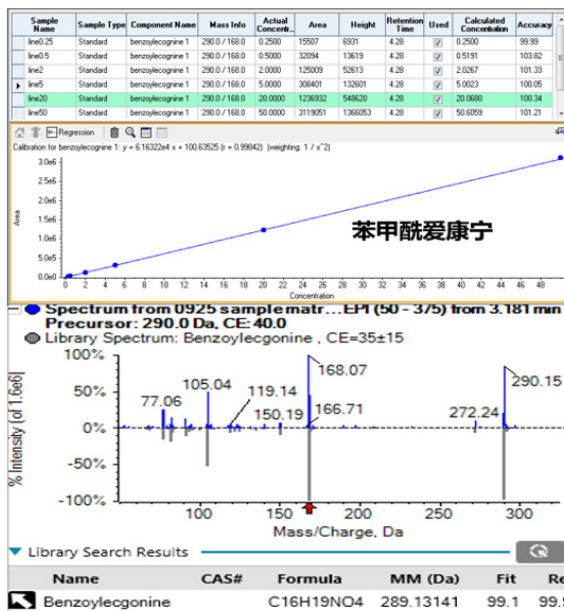
图6. 一针进样既有MRM定量数据，又有EPI定性图谱，同一界面数据处理
