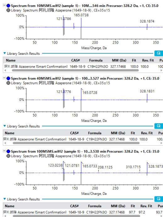
图6. 不同扫描速度对阿扎哌隆的二级谱图质量无明显影响（上：TOFMS_IDA_10MSMS；中：TOFMS_IDA_40TOFMSMS；下：TOFMS_IDA_100TOFMSMS）
