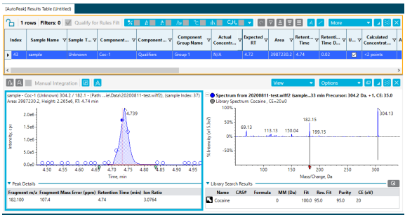
图3. 实际样品检测色谱图（通过增强型离子扫描获得全面的二级质谱图，通过软件进行数据库的自动匹配，保证了检测结果的完整性以及准确性）
