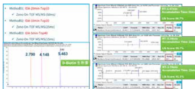
图6. 细胞上清液样本中的生物素在不同梯度运行时间（20min, 10min, 5min）下的TOF MS XIC谱图，和MS/MS谱图匹配情况。
