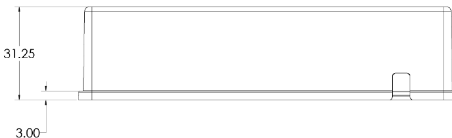
Abbildung A-3: Probenplatte in der Seitenansicht - Abmessungen
