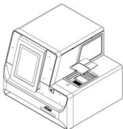
図 7-4 : フローティングカバーの取り外し
