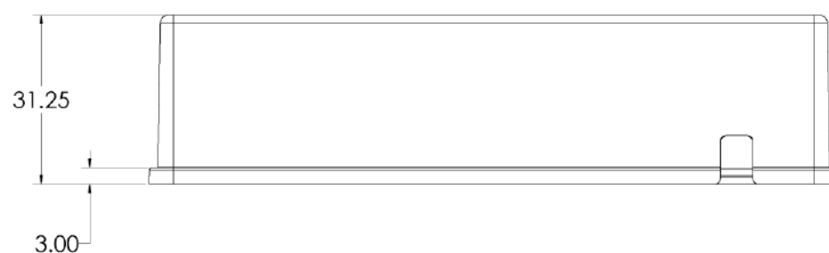
図 A-3 : サンプルプレート側面の寸法
