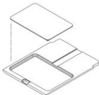
図 7-5 : サンプル蓋とフローティングカバー
