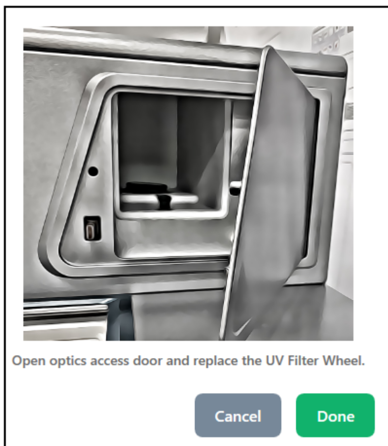
図 7-7 : 光学コンパートメントのアクセスポア
