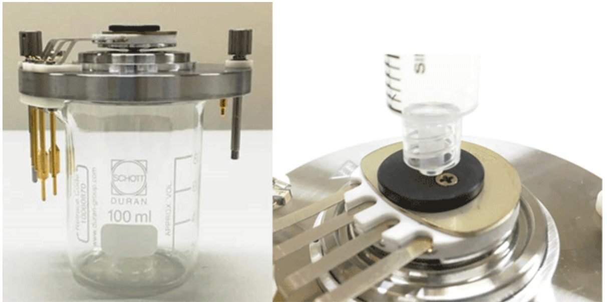
Figura 4-6: Conjunto del calentador de celdas nano en el vaso de boca ancha y la jeringa
