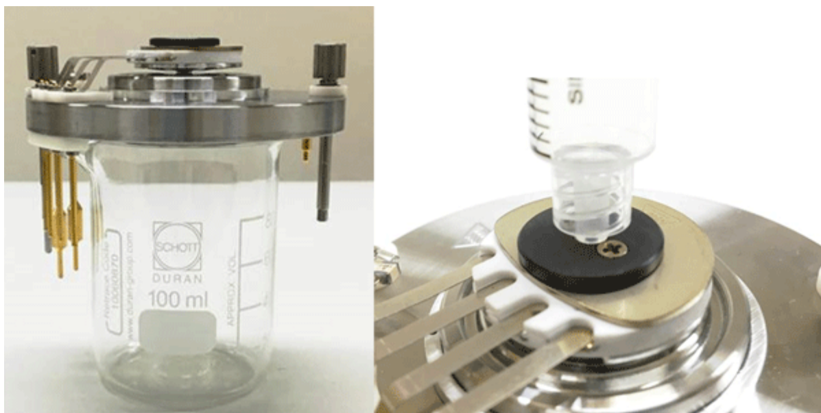
図 4-6 : ビーカーの上に置いた Nano Cell ヒーターアセンブリとシリンジ
