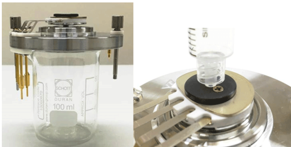
图 4-6 烧杯上的 NANO 池加热器组件和注射器
