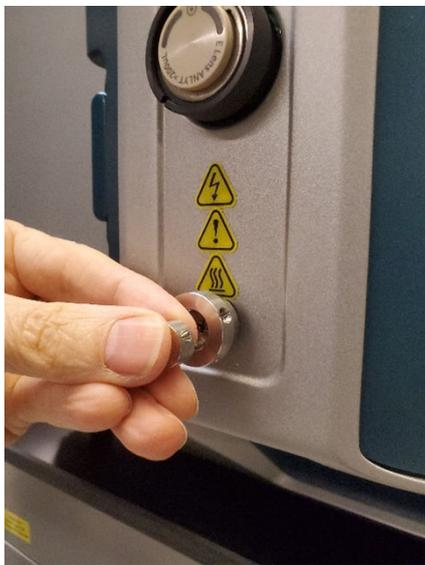
5. Installez les raccords de 1/16 po pour aligner correctement la jonction sur le raccord du T de mise à la terre.
