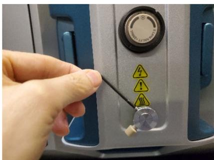
7. Installez la source d'ions sur le spectromètre de masse. Consultez la section [Installer la source d'ions sur le spectromètre de masse](#).
