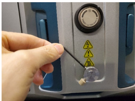
Figura 3-7: Serraggio della vite prigioniera
