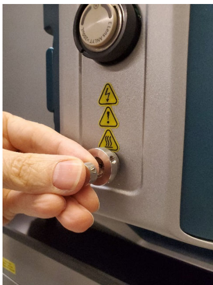
図 3-5 : 継手部の取り付け
