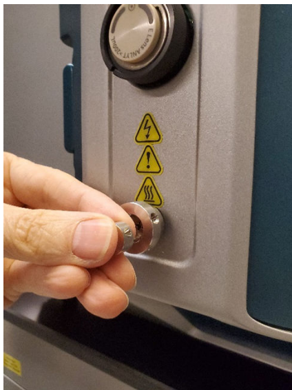
Figura 3-5: Instalar a união
