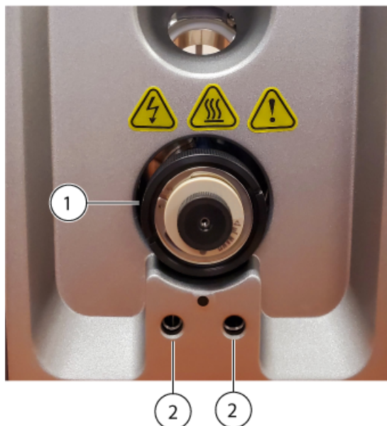
Figura 3-18 Conexión del calentador de columna Nano en la fuente de iones
