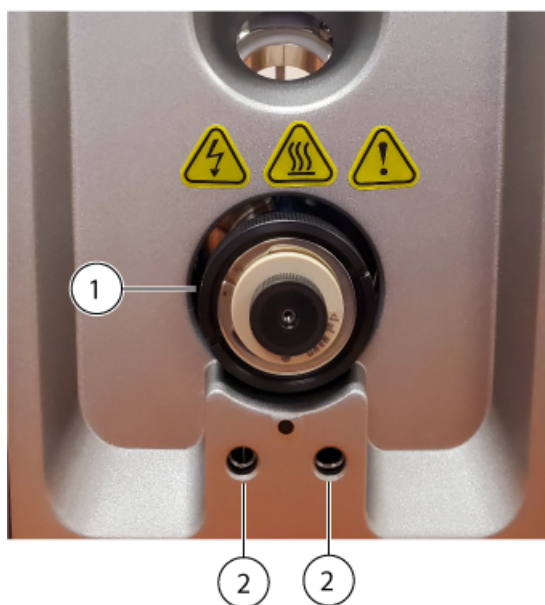
Figura 3-18 Collegamento del riscaldatore della colonna Nano sulla sorgente di ionizzazione
