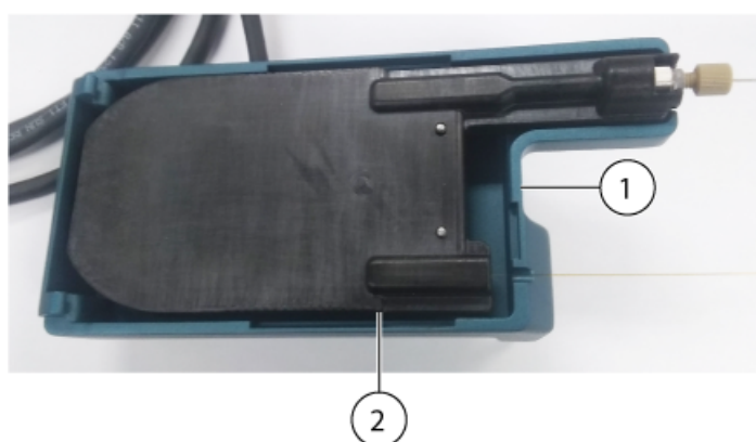
Figura 3-15 Parte posteriore del riscaldatore della colonna Nano
