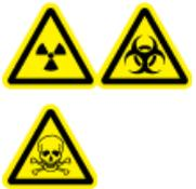
警告！ イオン化放射線障害の危険性、生物学的危険、または有害化学物質の危険性。クリーニングやメンテナンス前に、汚染除去が必要かどうかを判断します。放射性物質、生物学的病原体、または有害化学物質が質量分析装置に使用された場合、お客様はクリーニングまたはメンテナンス前にシステムに対して汚染除去を行う必要があります。
