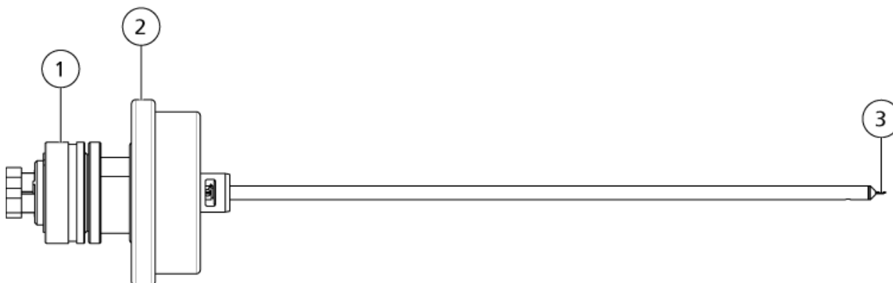
Abbildung 2-2: Teile der ESI-Doppelsonde
