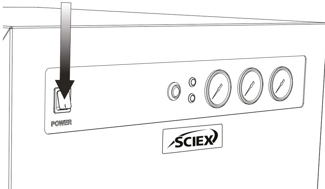
**ALLUMEZ** le générateur à l'aide de l'interrupteur situé sur le panneau avant.
