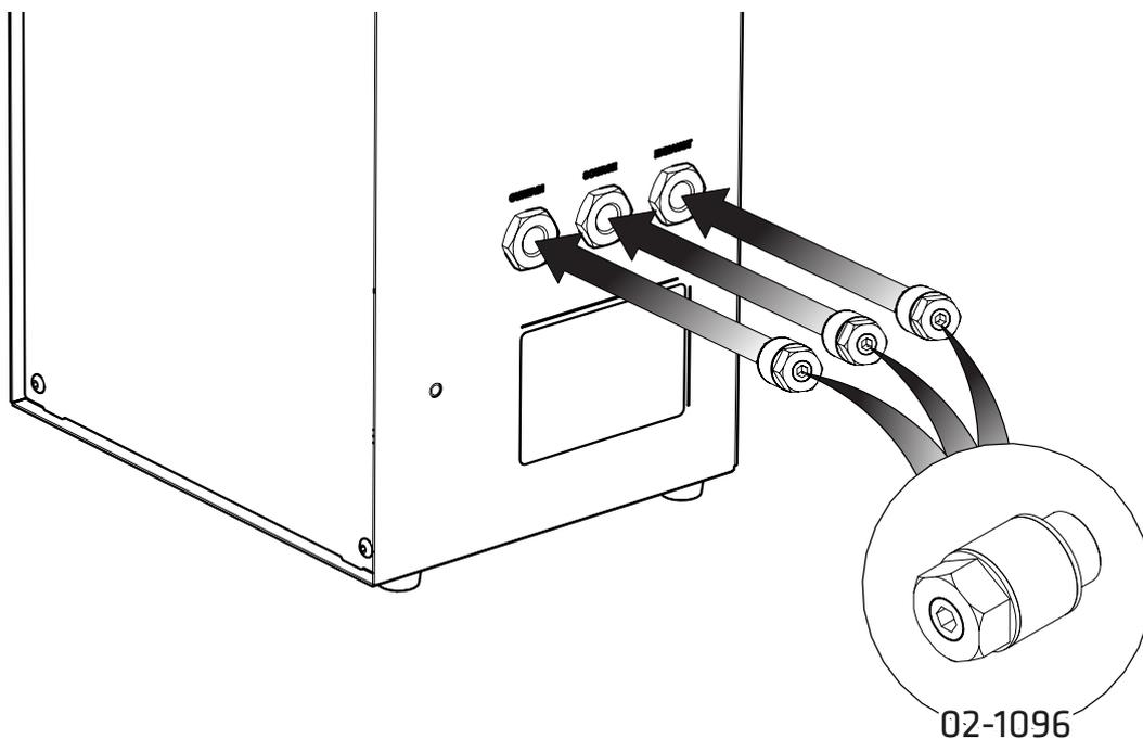
Selezionare il **silenziatore di controllo del flusso 3 × 02-1096** e collegarli alla **tenda, alla sorgente** e alle porte **di scarico** sul lato destro del generatore.
