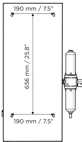
Il generatore può essere montato a parete, **se non si desidera montare a parete il generatore procedere al passaggio 4.**
