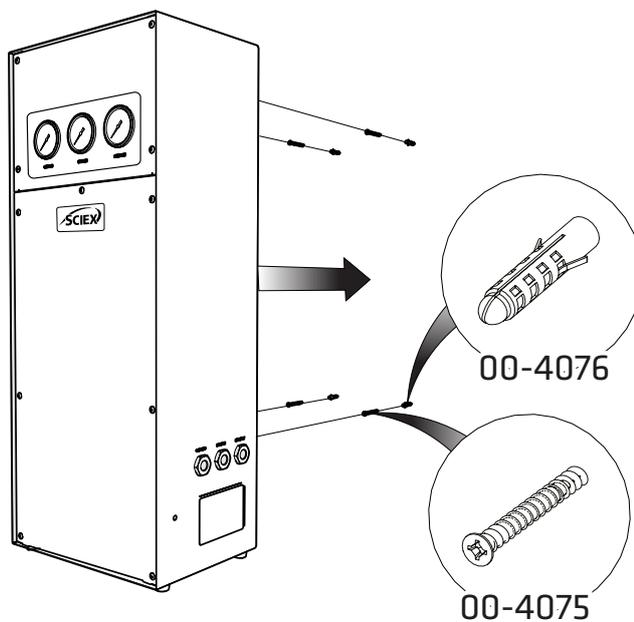
Con i fori praticati nella posizione desiderata, montare la **spina a parete n° 4 x n° 8 00-4076** e la **vite n° 4 x n° 8 00-4075** a parete e montarvi sopra il generatore.
