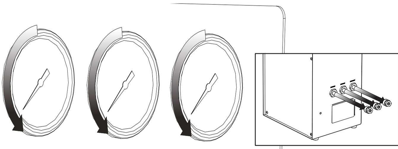
Lo spurgo è stato completato. Scollegare l'alimentazione dell'aria e, una volta che i manometri sulla parte anteriore del generatore presentano un valore pari a 0, i **raccordi del silenziatore possono essere rimossi** dalla tenda, dalla sorgente e dalle porte di scarico.
