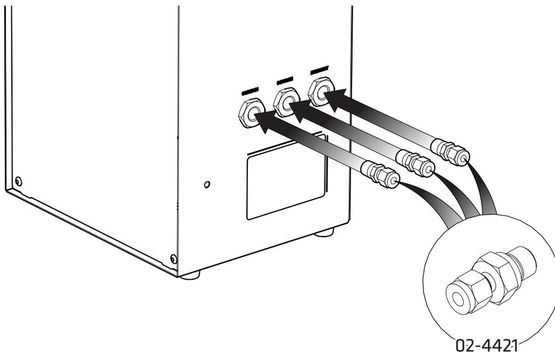
Selezionare i **raccordi a compressione 3 × 1/4" 02-4421** e collegarli **alla tenda, alla sorgente** e alle porte di **scarico** sul lato destro del generatore.
