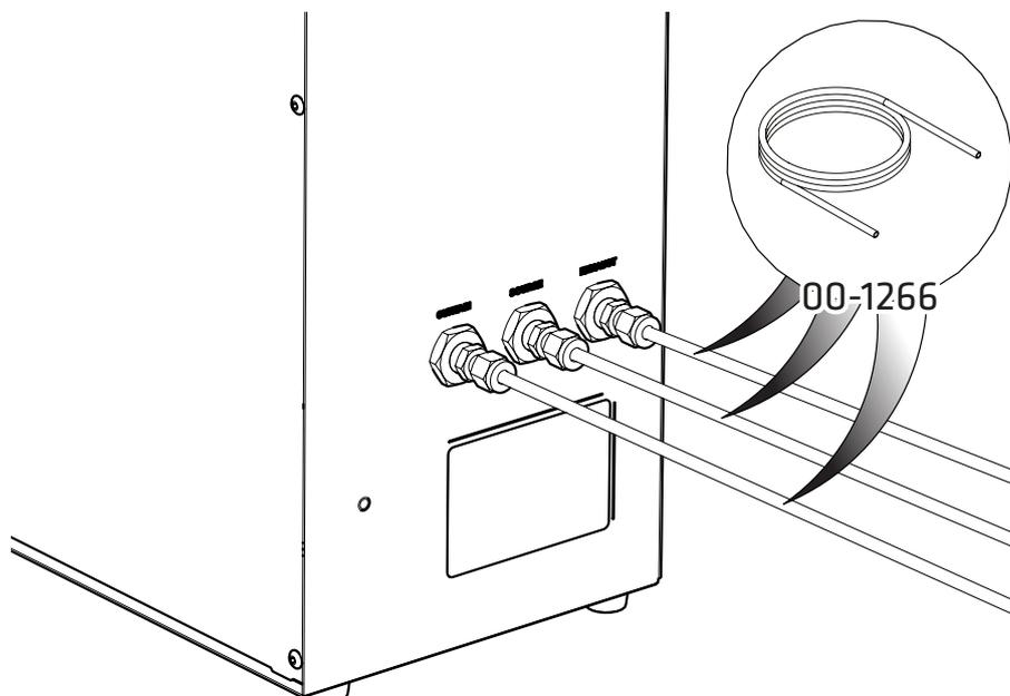
Selezionare il **tubo in PTFE da 1/4" 00-1266** in dotazione e collegarlo ai tre **raccordi a compressione da 1/4" x 1/4" 02-4421**.
