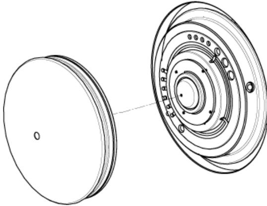
Die Curtain-Platte wird von drei Kugelrasten gehalten, die auf der Orifice-Platte angebracht sind.
