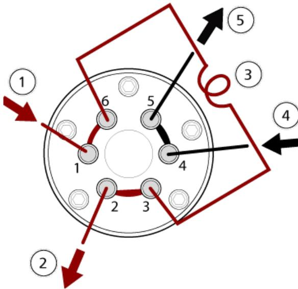
Abbildung 3-6 Umleitventil – Injektormodus Position B
