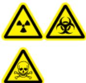
**WARNHINWEIS!** Strahlengefährdung, Biogefährdung oder toxisch-chemische Gefahren. Klären Sie vor der Reinigung oder Wartung, ob eine Dekontamination erforderlich ist. Der Kunde muss das System vor der Reinigung oder vor Wartungsarbeiten dekontaminieren, wenn radioaktive Stoffe, biologische Wirkstoffe oder giftige Chemikalien in dem System eingesetzt wurden.
