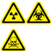
**WARNHINWEIS! Strahlengefährdung, Biogefährdung oder toxisch-chemische Gefahren. Achten Sie darauf, die Abluft über eine dafür vorgesehene Laborabzugshaube oder eine Abluftanlage abzulassen, und sorgen Sie dafür, dass die Abluftschläuche gut mit Schellen befestigt sind. Stellen Sie sicher, dass der Luftaustausch im Labor für die ausgeführten Arbeiten angemessen ist.**
