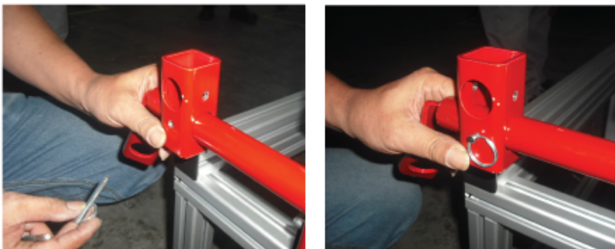
Abbildung 5-9: Kurzer Hebeblock montiert
