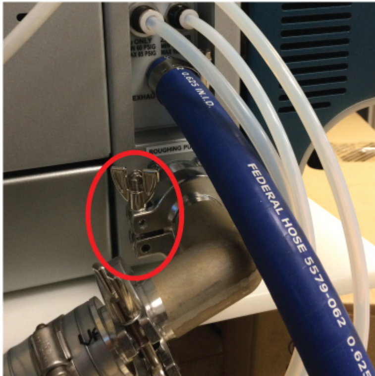
Figura 5-15: Morsetto correttamente installato
