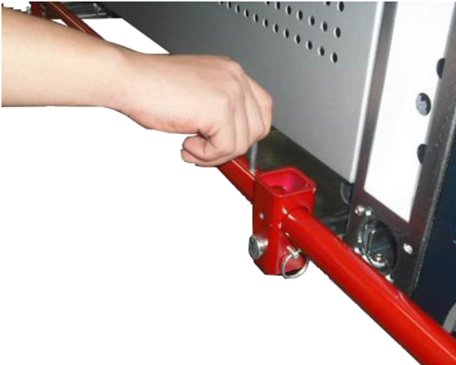
図 5-10 : ロングロッドへのロックピンの取り付け
