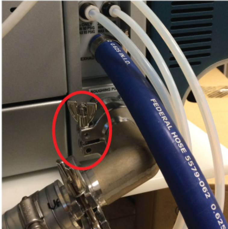
図 5-15 : 正しい取り付け方のクランプ
