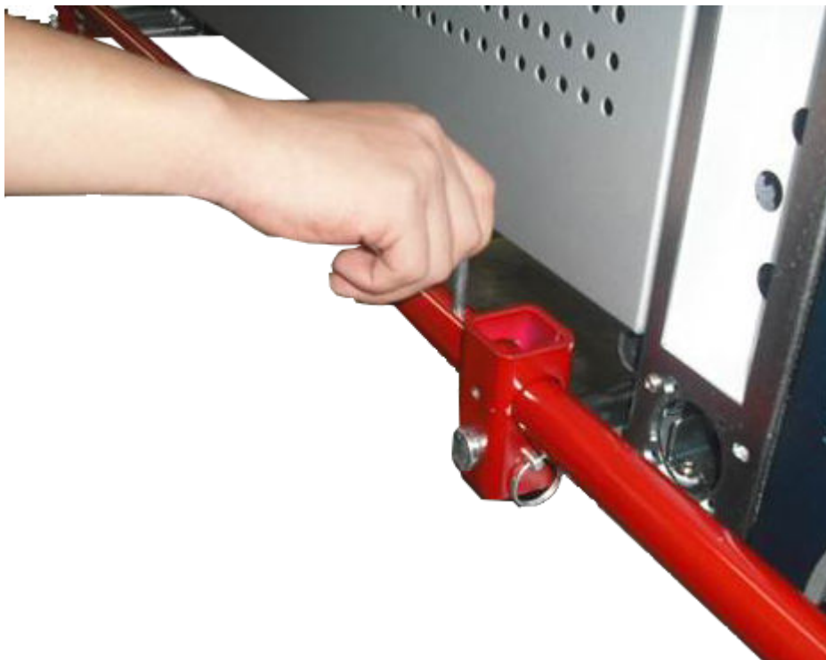
Figura 5-10: Instalação do pino de travamento na haste longa
