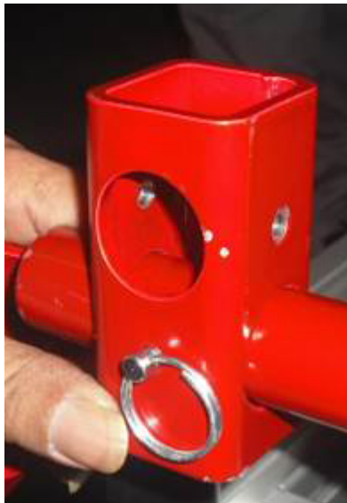
Figura 5-11: Bloco alto instalado
