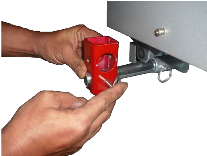
Abbildung 5-10: Kurzer Hebeblock montiert
