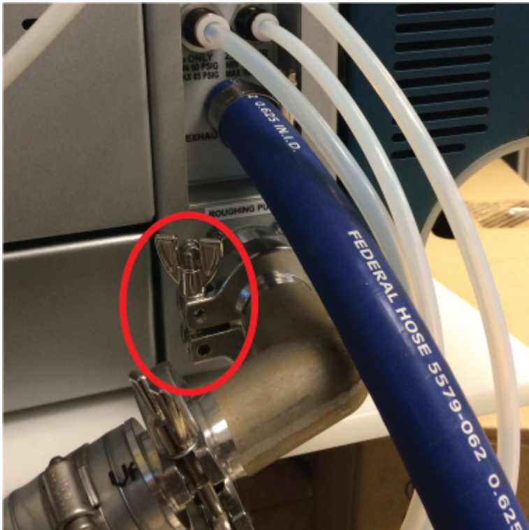
Abbildung 5-16: Richtig installierte Klemme
