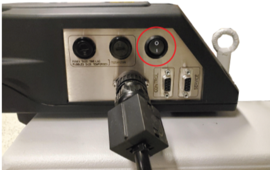
Illustration 3-1 : Pompe primaire à joint d'huile : interrupteur Marche/Arrêt
