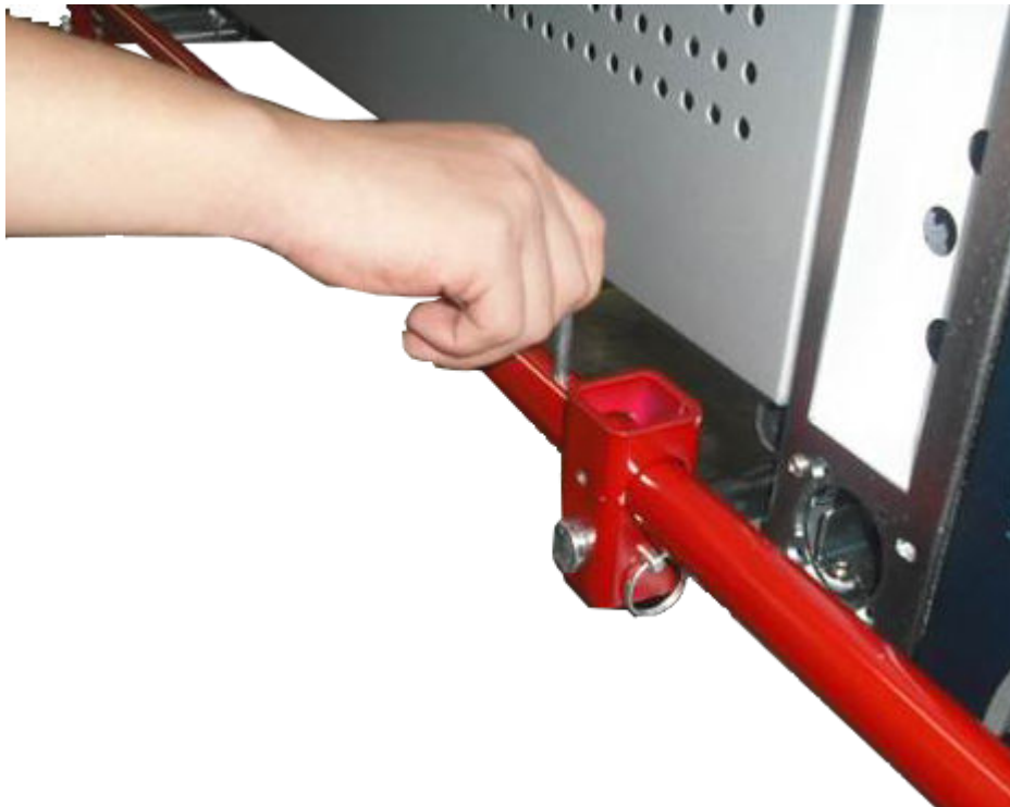
Illustration 5-11 : Installation de la broche de verrouillage sur la longue tige
