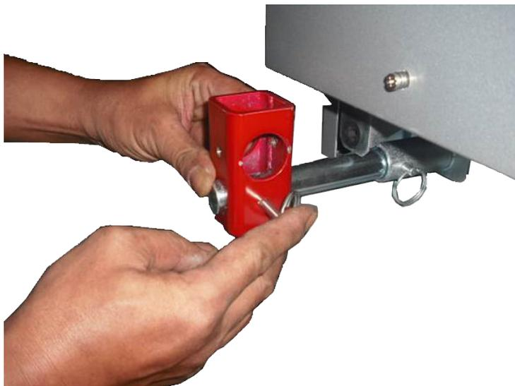
8. Sul lato destro dello spettrometro di massa, inserire un'asta lunga attraverso i blocchi.
