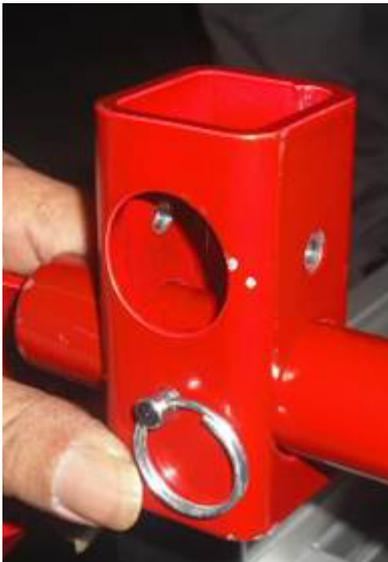
12. Sulla parte posteriore dello spettrometro di massa, inserire un'asta corta attraverso i blocchi alti.
