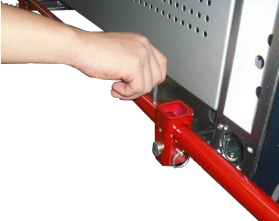
11. Installare i blocchi alti sulle estremità delle aste lunghe sul retro dello spettrometro di massa, quindi fissarli con due perni di bloccaggio.
