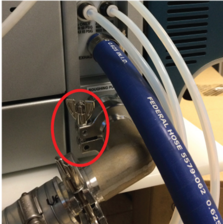
図 5-16 : 正しい取り付け方のクランプ
