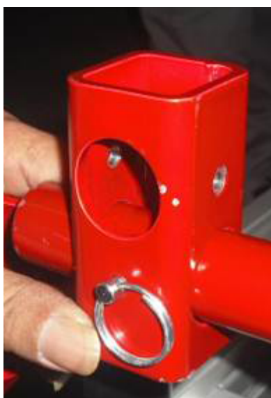
图 5-12 高挡块已安装
