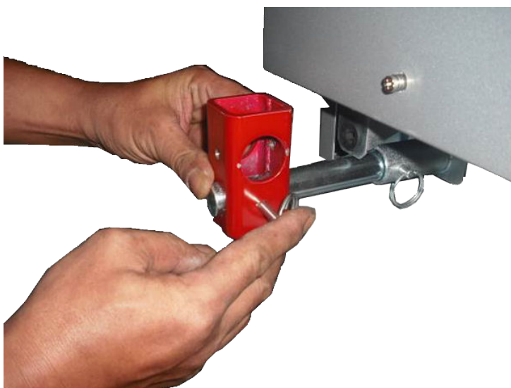
图 5-10 矮挡块已安装
