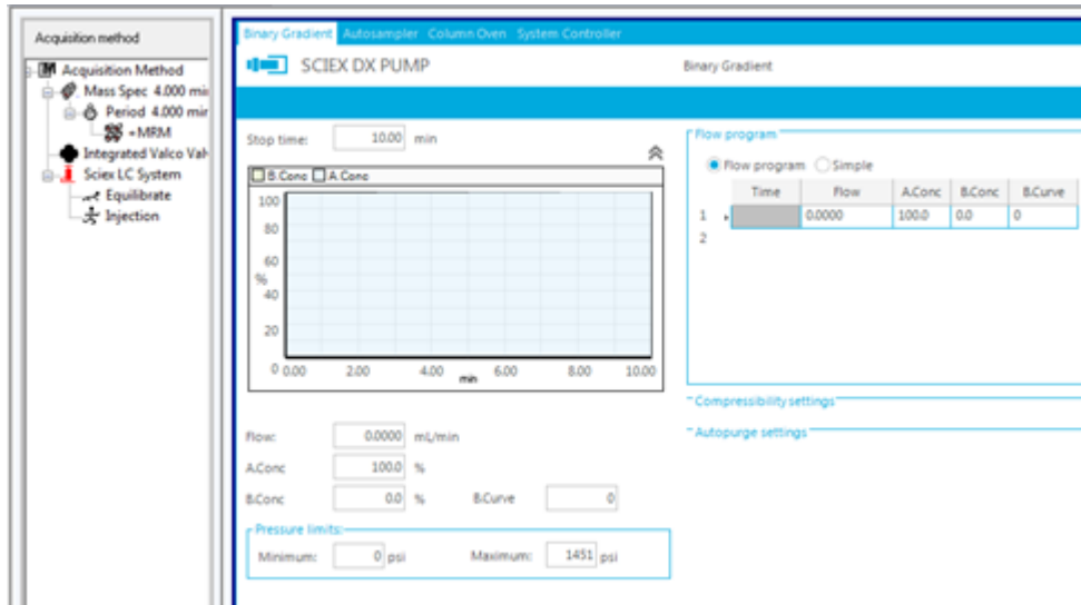
Figura 11-9: Parámetros de la bomba SCIEX DX
