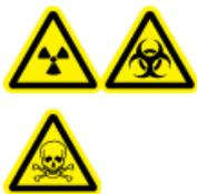
**AVVERTENZA!** Pericolo di contaminazione da radiazioni o esposizione ad agenti tossici chimici e rischio biologico. Determinare se sia necessaria la decontaminazione prima di effettuare la pulizia o la manutenzione. Il cliente deve eseguire la decontaminazione del sistema prima della pulizia o della manutenzione se sono stati usati materiali radioattivi, agenti biologici o agenti chimici tossici con il sistema.
