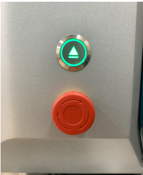
Abbildung 6-5 Drehen den Not-Aus-Taster im Uhrzeigersinn
