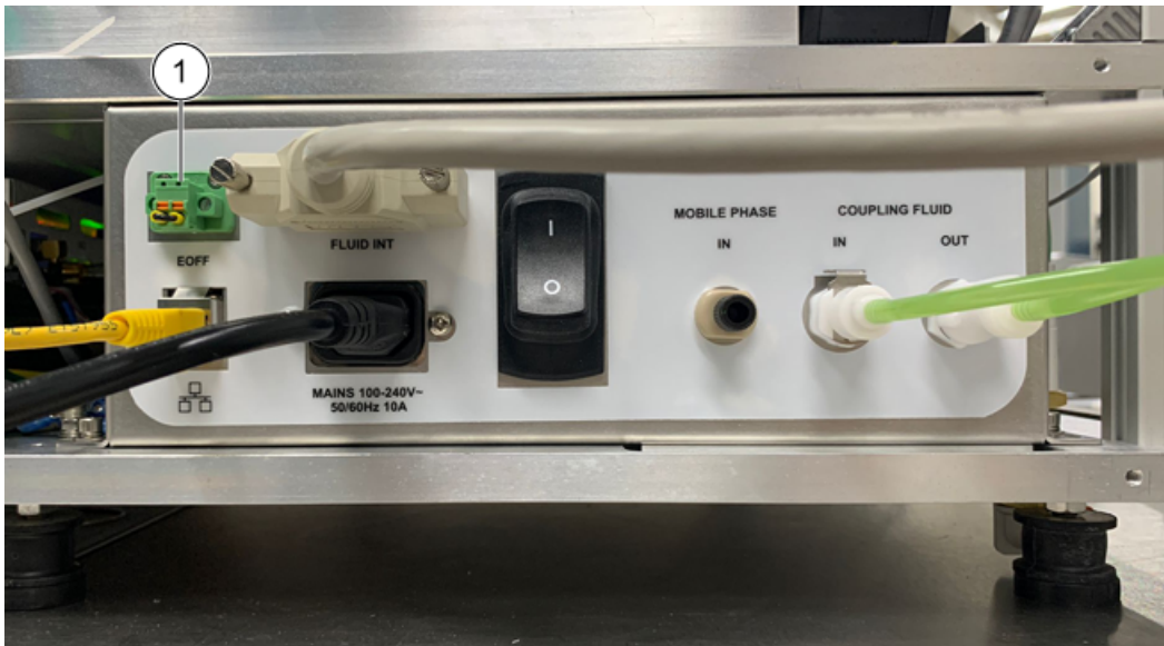
Abbildung 6-3 Not-Aus-Anschluss und -Stecker an der Rückseite des Echo ® MS-Moduls
