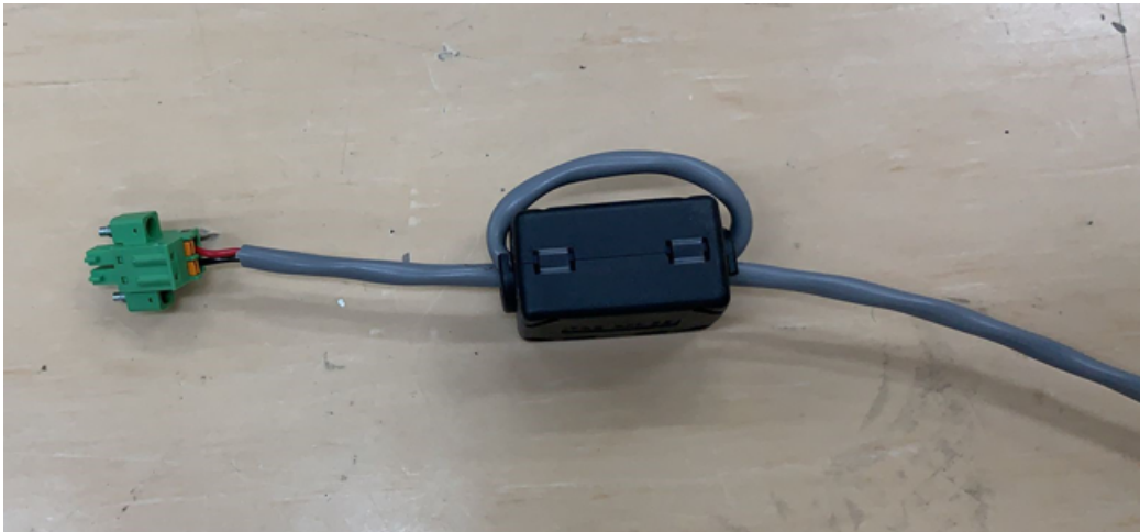
Abbildung 6-1 Abgeschirmtes Kabel oder ungeschirmtes Kabel mit Ferritkern
