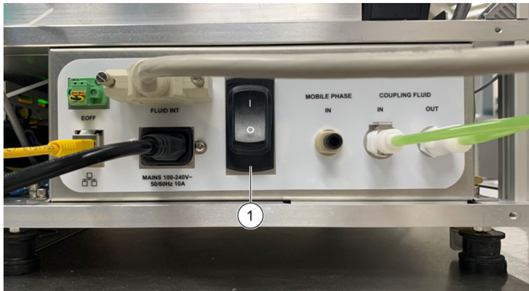
Abbildung 4-2 Netzschalter am Echo® MS-Modul
