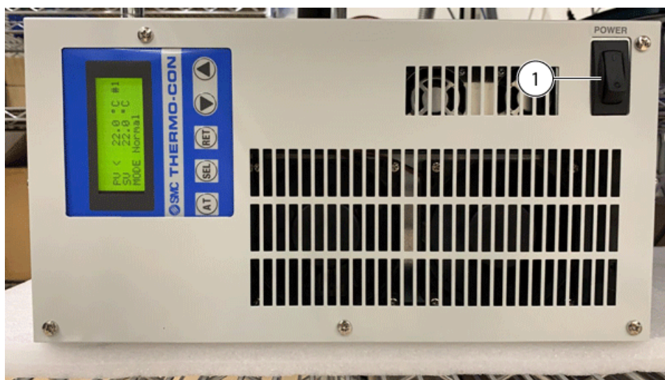
图 4-3 冷却器模块便捷开关
