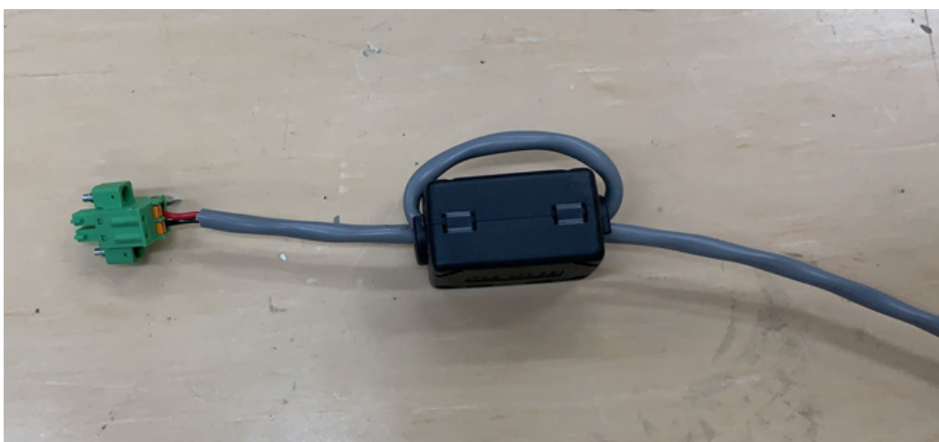
图 6-1 屏蔽电缆或添加铁氧体磁芯的无屏蔽电缆
