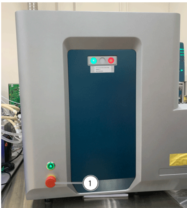
图 6-2 Echo ® MS 模块正面面板上的紧急关闭按钮
