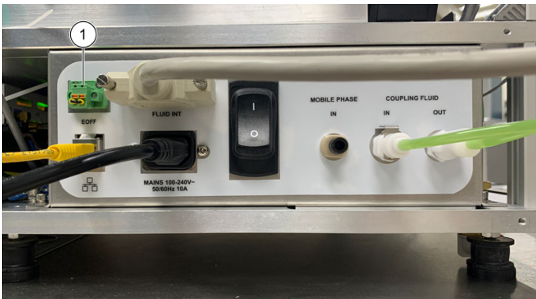
图 6-3 Echo ® MS 模块背板上的紧急关闭接头和插头
