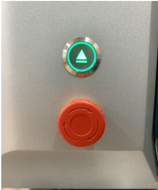
图 6-5 顺时针旋转紧急关闭按钮
