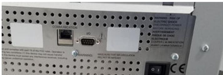
Abbildung 2-41: AUX-I/O-Port des Massenspektrometers
