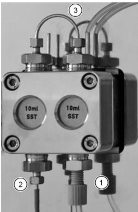
1. Halten Sie den Pumpenkopf mit einer Hand fest und ziehen Sie die vier Sternschrauben abwechselnd fest.
