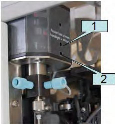
8. Ziehen Sie das Spritzenventil nach unten, um es aus dem Modul zu entfernen.
