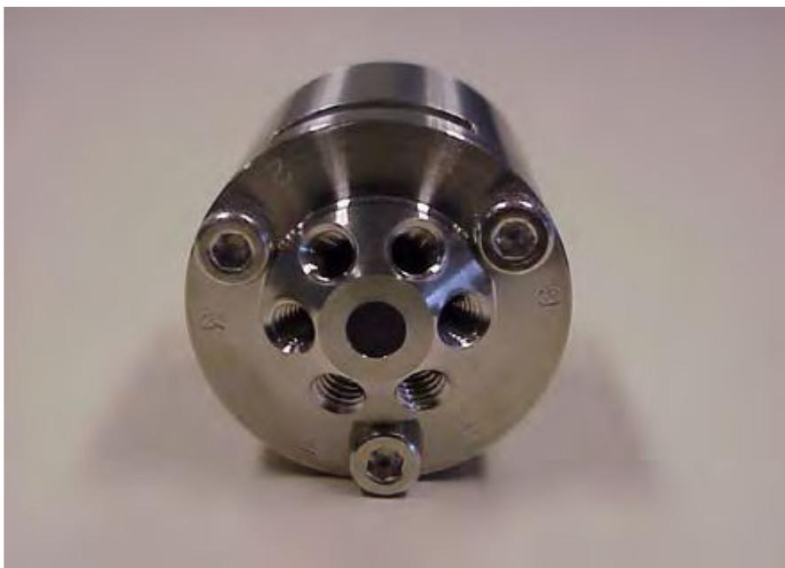
5. Installieren Sie das Injektionsventil mit den Anschlüssen 6 und 1 nach oben zeigend.
