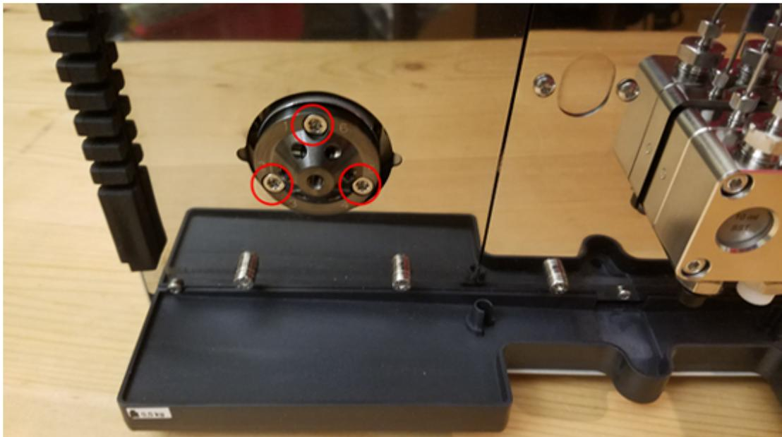
3. Entfernen Sie den Stator vom Ventilkörper.
