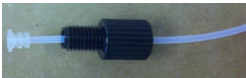
图 3-5 冲洗管路及金属箍
