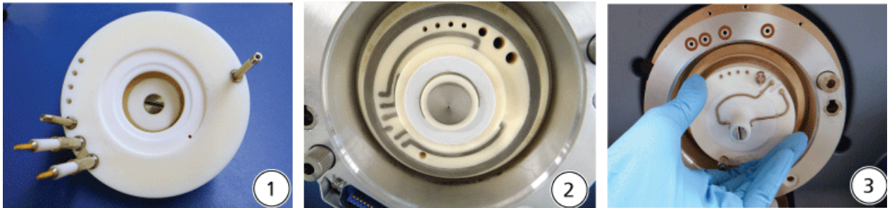
Figura 2-6 Installazione della cella di mobilità ionica
