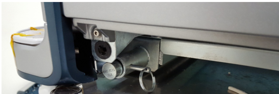
Figura 6-8: Barra de izado contraída
