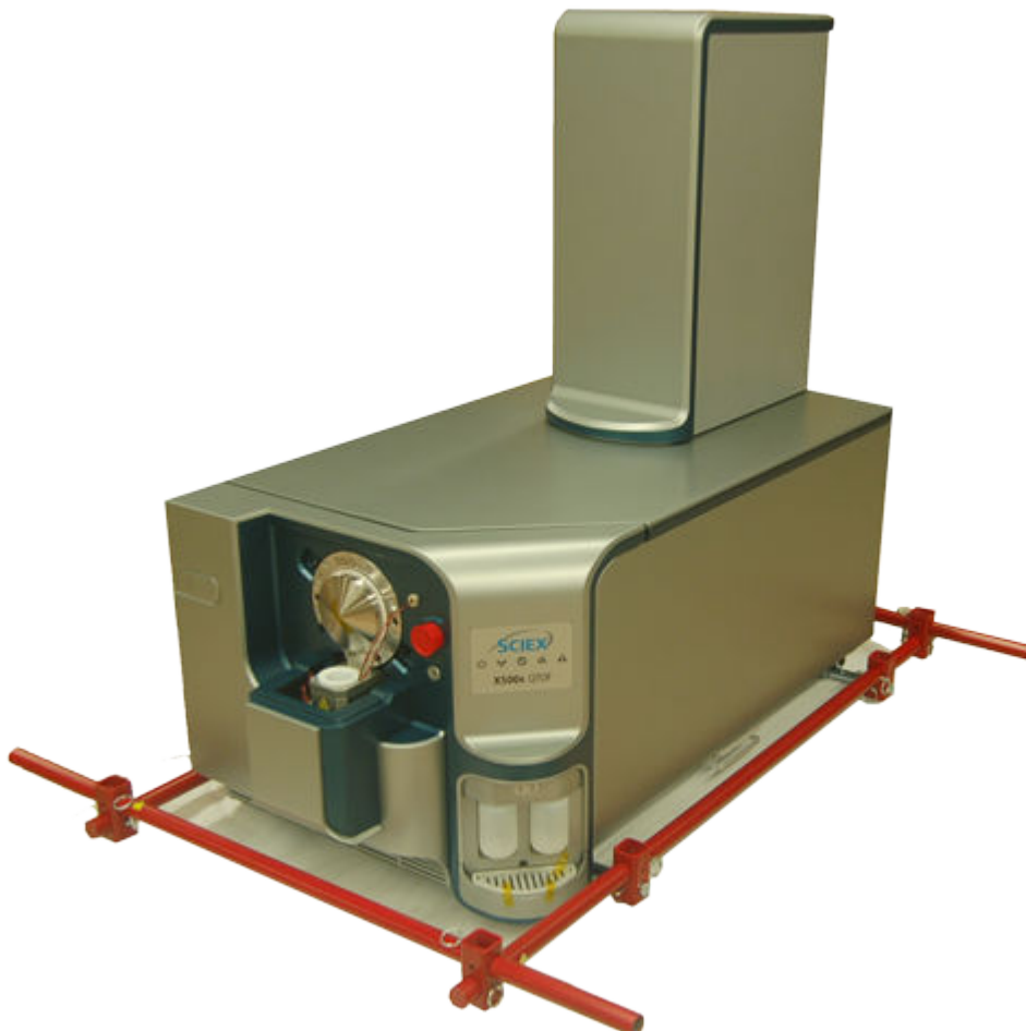
Figura 6-14: Kit de izado instalado (sistema X500R)
