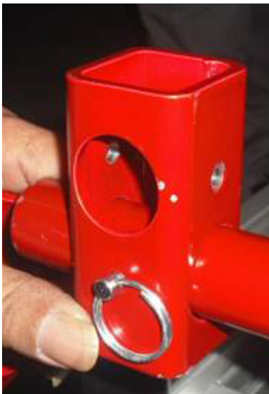
図 6-12 : トールブロックの取り付け
