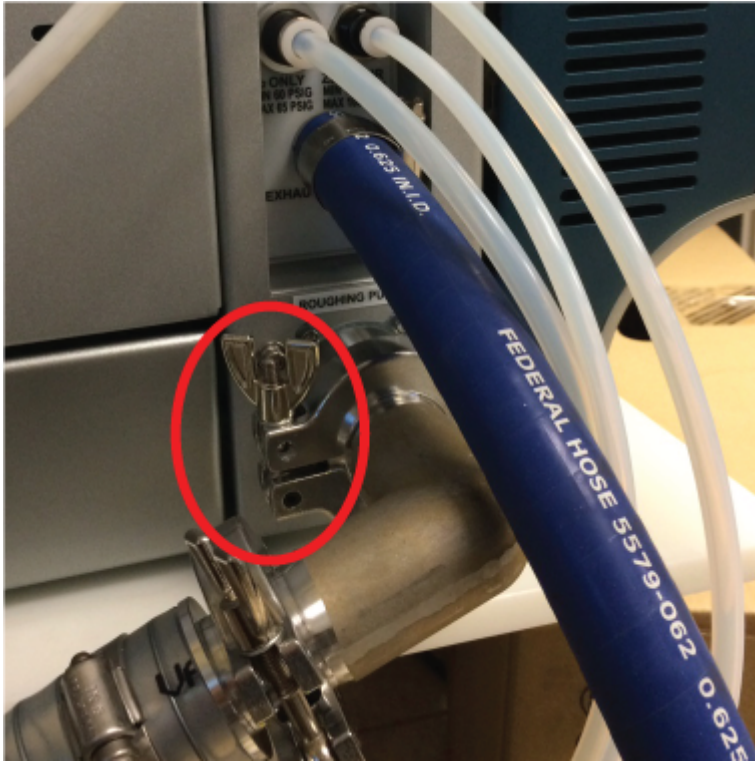
図 6-16 : 正しい取り付け方のクランプ
