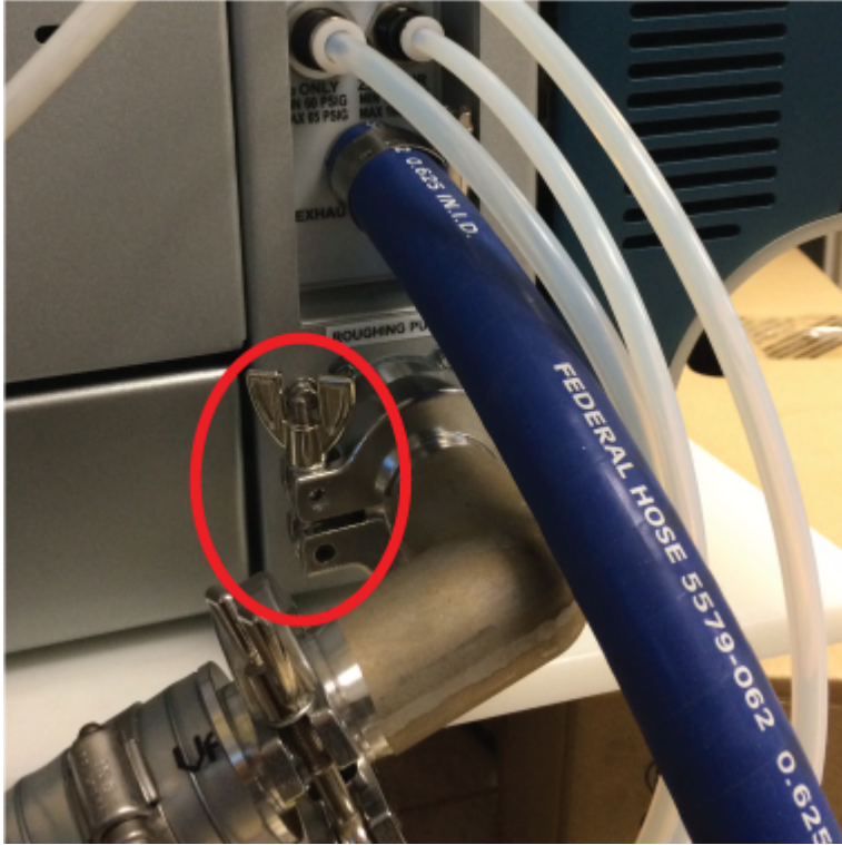
그림 6-16 올바르게 설치된 클램프
