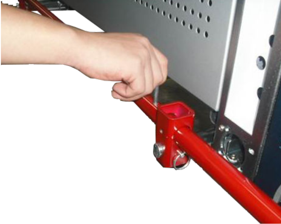
그림 6-11 긴 봉에 잠금 핀 설치
